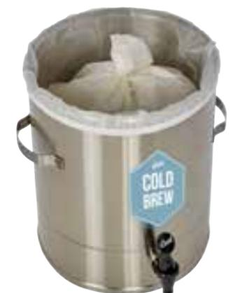
Ate el filtro con una de las cuerdas y vierta 15 litros más de agua fría en el contenedor. Deje reposar de 12 a 24 horas. Retire los filtros y diluya con agua.
